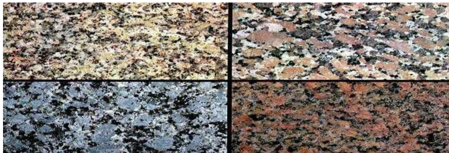
Рисунок 2.2. Массивная текстура гранитов
