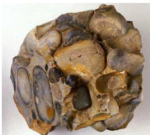
Рисунок 3.4. Сцементированные обломки осадочных горных пород
